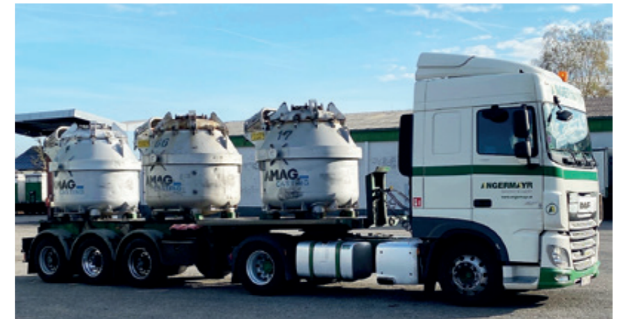
NICHT 08/15 Mit zehn derartiger Spezialauflieger wird flüssiges Aluminium transportiert.
